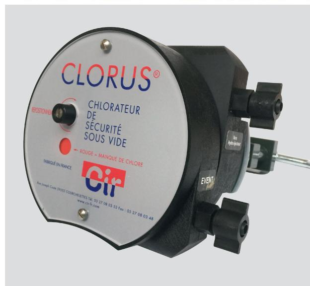
9 Un premier clapet anti-retour de l'hydro-éjecteur protège le système des pressions allant jusqu'à 15 bars. Un second clapet à membrane sur ressort assure une étanchéité parfaite même s'il n'y a pas de contre-pression pour forcer le siège en fermeture.
